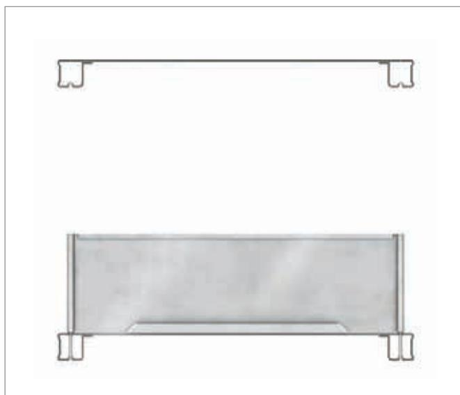
Detalle de fijación en panel superior e inferior.
