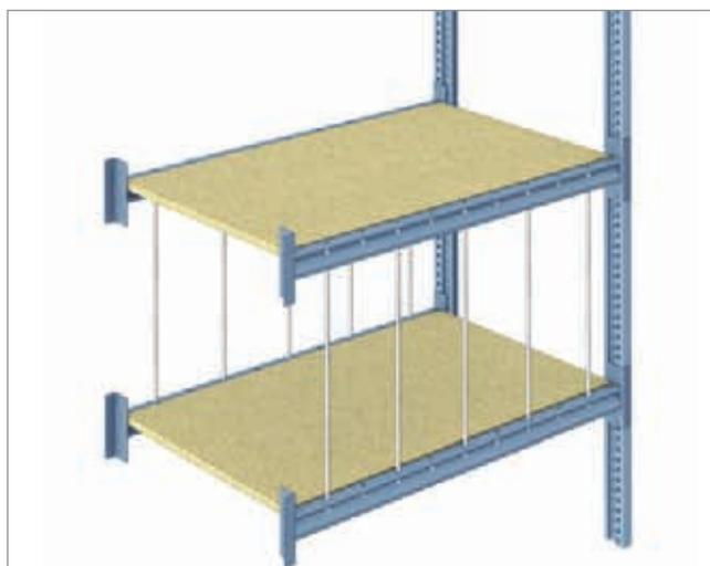
A las separaciones verticales, se les puede colocar fundas formadas por un tubo de plástico flexible que evita el roce directo entre el producto y el tubo metálico (figura 3).
